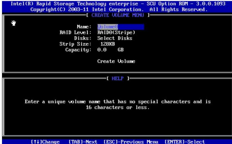
按<↑>,<↓>键光标上下移动, 在 RAID Level 处选择所需要建立阵列的级别, 可选项有 RAID0、RAID1 和 RAID5。选择完阵列级别及所要做阵列的硬盘后, 敲 Create Volume 选项按提示选择 ‘Y’ 创建阵列。如下图所示:
