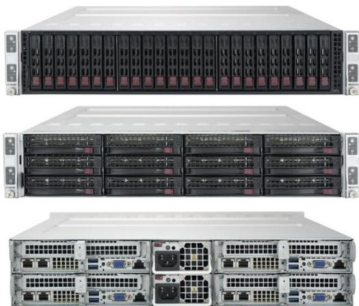
YH-5204Cv5 是一款高扩展性 2U 双路四子星服务器，最大可支持 8 颗 TDP≤165W 的 Intel Xeon SP 可扩展处理器 CPU。单节点提供 16 个 RDIMM 内存扩展槽，最大可扩展 2TB 内存容量；单节点支持 12\*3.5"或 24\*2.5"硬盘扩展位，可灵活扩展 SATA/SAS 硬盘以及 SSD 固态硬盘；每节点提供 2 个标准 PCIe 扩展槽以及 1 个 SIOM 网卡扩展槽。
